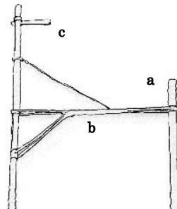
**架線柱を設置する際**、お手元のレイアウトに対してドリル、ルーター、ピンバイスなどを用いた1.5ミリ径の穴あけ作業が必要です。柱間隔は38ミリ（柱中心位置基準）となっておりますが設置箇所のカーブの状態やカントの有無、走行車両のサイズを元に、適切なクリアランスが確保できる位置を十分検討の上設置して下さい。カーブ区間に設置の場合、左右共に同じクリアランスになるとは限りませんのでご注意下さい。柱材は発注いただいた際の状況により長めの切り出しを行っておりますので、お好みの長さに合わせて切断しご利用下さい。Vトラス型と単ビーム型とでは架線の状況により設置の高さが異なりますので、実物の設置状況を参考に梁部材の高さを設定して下さい。各部材の固定には瞬間接着剤を強くお勧めします。
